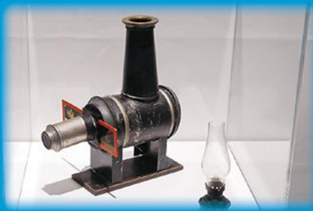
19世紀のアルコール・ランプを光源としていたマジック・ランタン(幻灯機)
